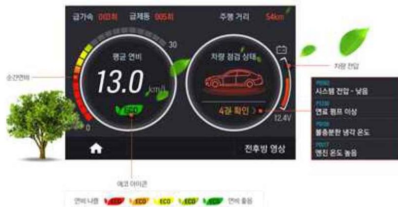
(그림 17) OBD-II 연결을 통한 차량 정보 획득
