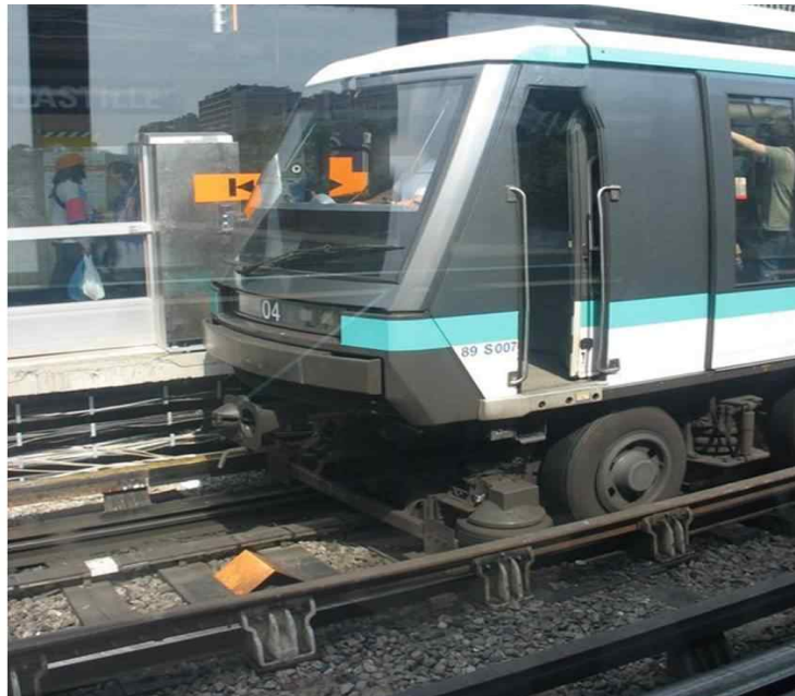
<그림 4-16> 철제레일 위를 주행하는 고무바퀴 차량의 예(파리메트로)
