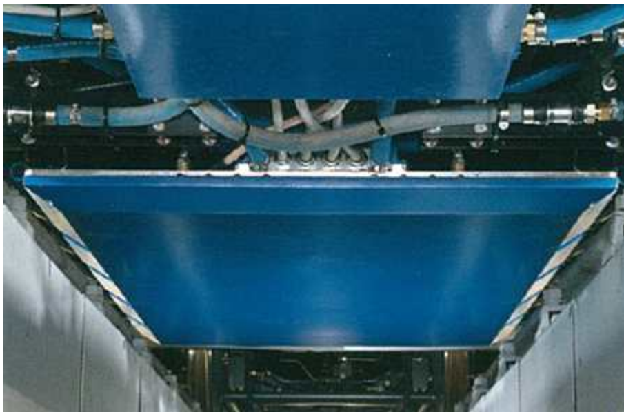
[그림 2-26] 차량 하부에 장착된 픽업 모듈
