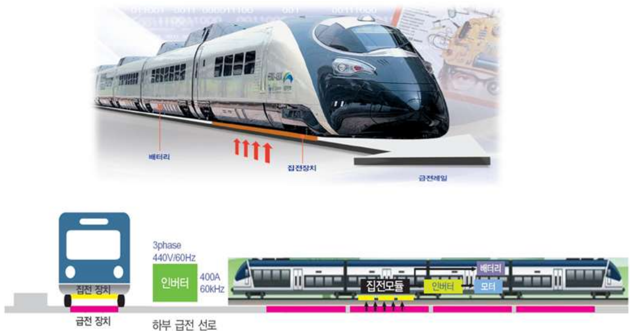
[그림 1-4] 무선 급전 철도 시스템의 개념 및 원리
