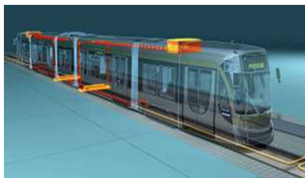
[그림 2-20] MITRAC Energy Saver를 탑재하여 에너지 사용량 최대 30% 감소
