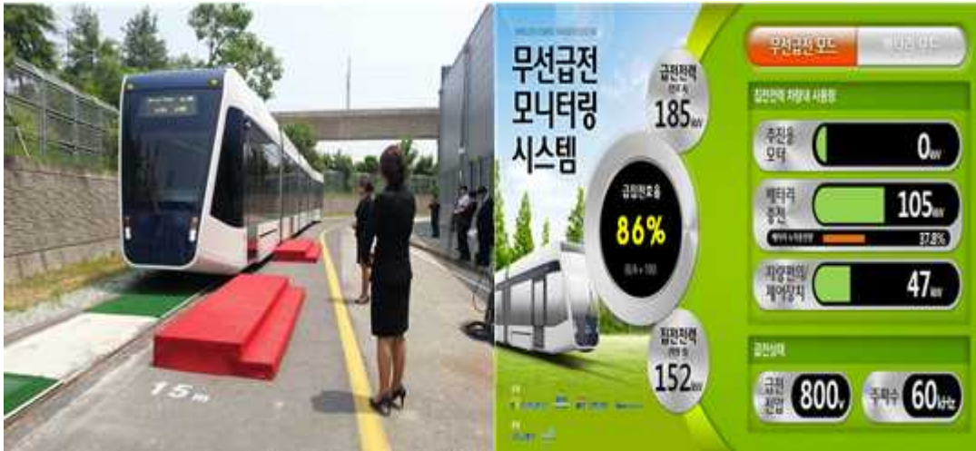
[그림 8-9] 무선급전 180kW 트램차량 적용시험(좌) 및 급전 효율 모니터링(우)
