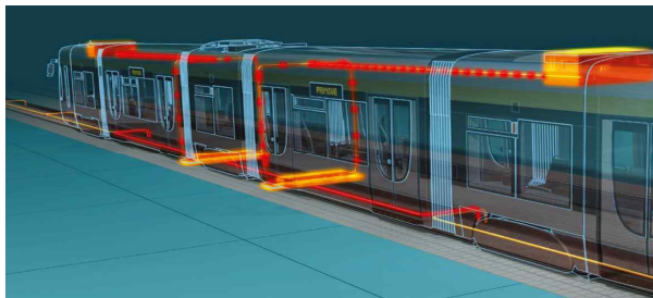
[그림 2-14] Primove 열차의 에너지 전송 (개념도)
