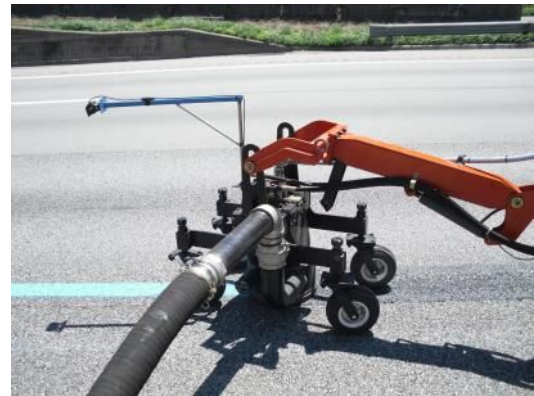
<그림 2-11> 차선제거기(좌) 및 차선제거 작업 전경(우)
