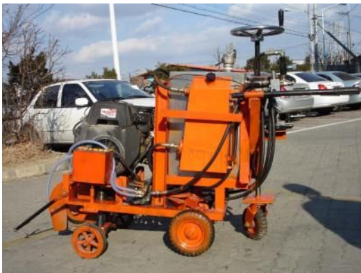
<그림 2-10> 배수홈 절삭기(좌) 및 배수홈 절삭 작업 전경(우)
