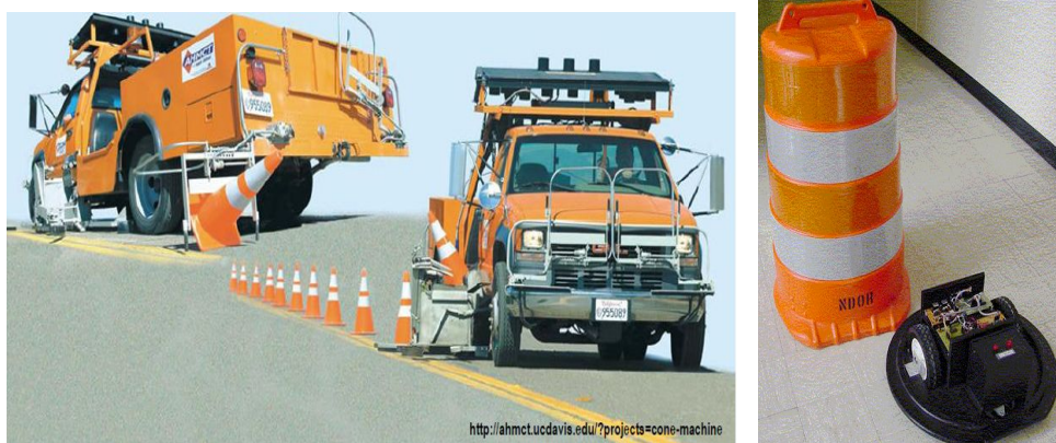
<그림 2-19> 임시 교통통제시설 자동 설치/철거 장비
