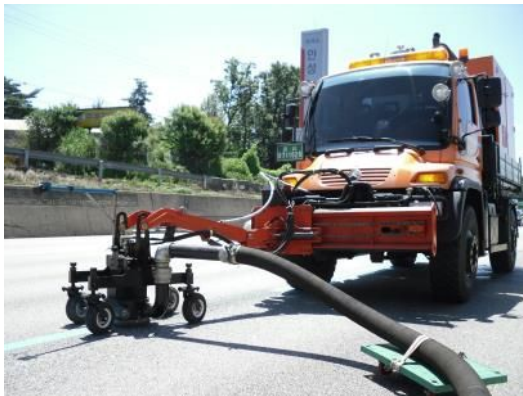
<그림 2-11> 차선제거기(좌) 및 차선제거 작업 전경(우)
