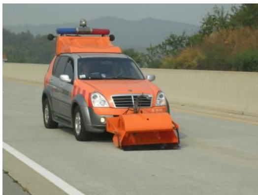
〈그림 2-7〉 낙하물수거기(좌) 및 표지판 청소차(우)
