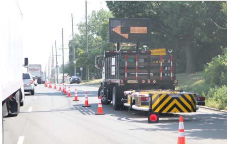
<그림 2-5> 트럭에 탑재한 완충장치
