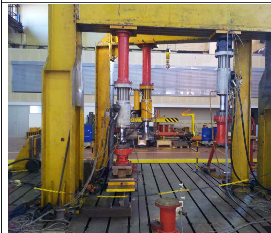
베어링 시험기 전경 (일반 액츄에이터 및 프레임 이요)
