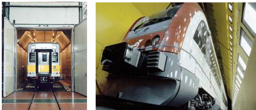
[그림 3-74 실대형 환경챔버의 외관 사진]
