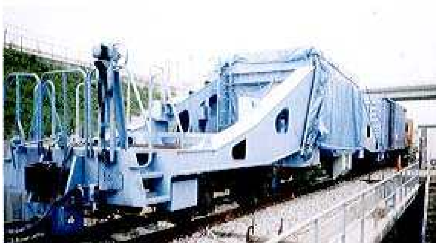
[그림 3-8 이동식 궤도동적재하시험기]
