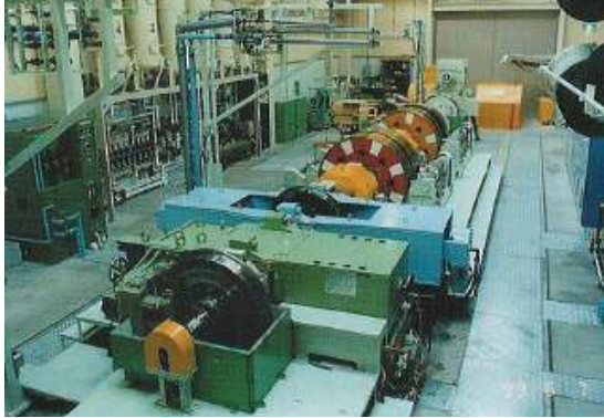
Creep force test apparatus
