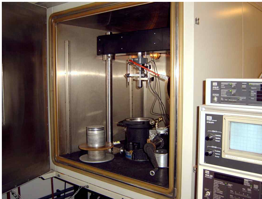
[그림 3-57 시험환경의 조절이 가능한 재하장치]
