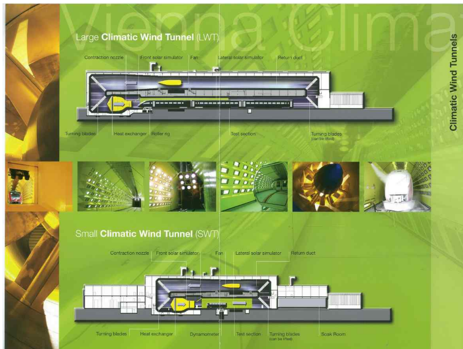
[그림 2-20 오스트리아 RTA 철도차량 대형환경 풍동시험시설]
