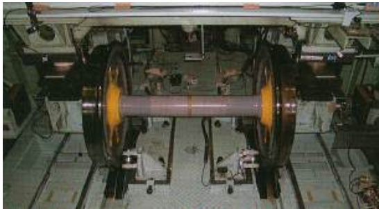
Creep force test apparatus
